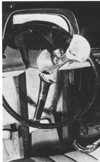
Abb. 5. Lenkung ohne Dämpfungselement nach Aufprallversuch: Lenkradkranz mit Speichen von der Nabe abgebrochen
